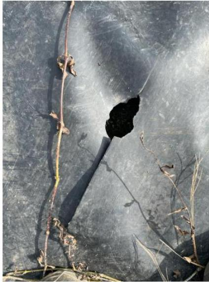
**Ilustración 7.** Ruptura de geomembrana en la celda de disposición final de desechos.
